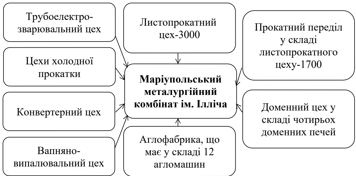
Рис. 2.1. Склад підрозділів «Маріупольського металургійного комбінату ім. Ілліча».
