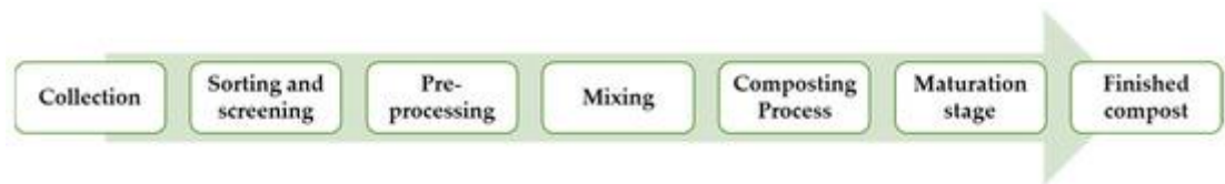
Рис. 3.2. Процес компостування органічних відходів [6]
